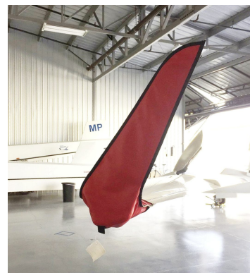
Schleicher ASH Wingtip Pads
